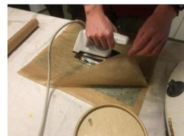
Schritt 4: Das Stofftuch wird zwischen zwei Backpapiere gelegt. Mit dem heißen Bügeleisen lässt sich das Wachs gut verteilen. Überschüssiges Wachs lässt sich entfernen, indem ein noch unbestrichenes Tuch beigelegt wird.
